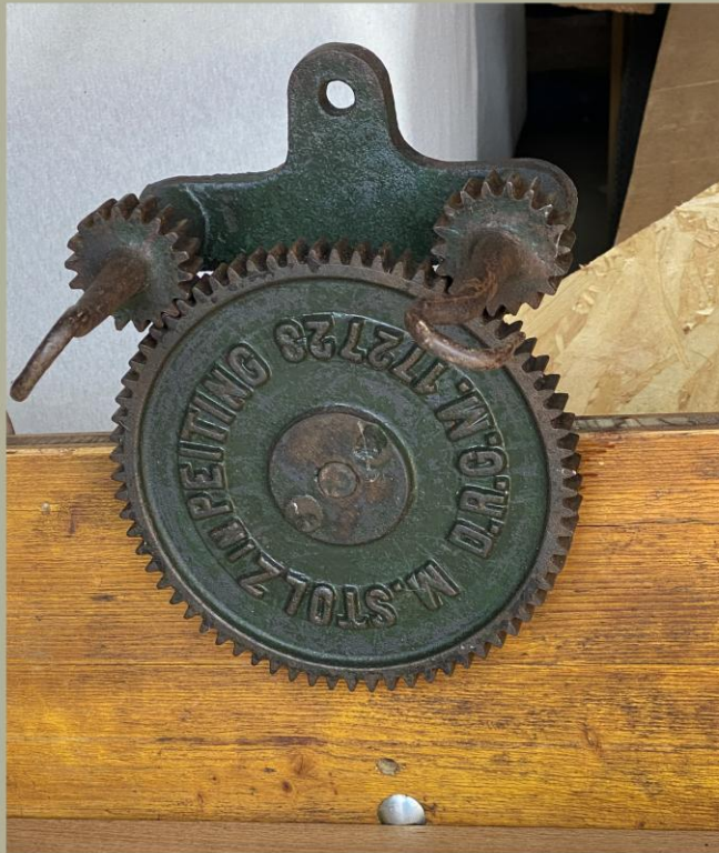
Links eine alte Seilerkurbel, die sich im Besitz von Engl Thomas befindet. Damit können mehrere Stränge miteinander verdreht werden, um daraus Seile herzustellen.
